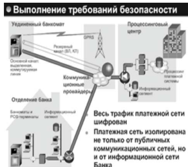
Рисунок 1 — Защищенные каналы связи между субъектами платежной системы
